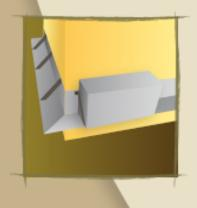
Le bas des équerres de soubassement doit être situé à 15 cm au-dessus du sol extérieur. Les équerres de soubassement mesure 1m20 de long.
