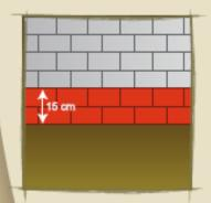
Les briques sont posées sur un soubassement maçonné de 15 cm de hauteur minimum au-dessus du sol fini. Cette semelle doit également comporter une couche de mortier hydrofuge pour garantir la rupture de capillarité. Pour recevoir le 1er rang de briques, l'arase du soubassement doit respecter les tolérances suivantes :
