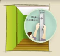
Pour une cloison en briques de 7 ou 10 cm d'épaisseur, suffisante en intérieur, tracez l'emplacement de la cloison au sol, sur les murs et au plafond en ajoutant une épaisseur de 10 à 15 mm pour les enduits de chaque côté. Utilisez un fil à plomb ou un niveau pour contrôler la bonne verticalité.
