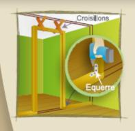
Le bâti est fixé solidement au sol à l'aide d'équerres. Si la cloison dépasse les 3 mètres de long ou si la hauteur dépasse celle d'un plafond habituel, il est prudent de prévoir un renfort, par exemple un chevron vertical fixé au sol et au plafond, à peu près au milieu du mur.
