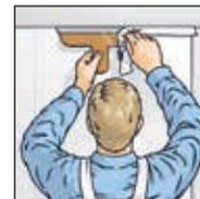
**6.** Procéder à la découpe dans les coins avec des ciseaux. Les professionnels arrachent également fréquemment l'ingrain dans les coins avec une spatule.
