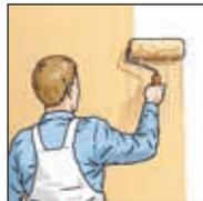
**8.** Après le séchage, recouvrir l'ingrain avec une peinture acrylique de qualité supérieure en conformité avec EN 13300.
